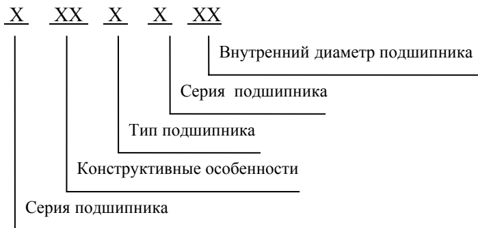
Рис. 16. Расположение цифр в основном условном обозначении подшипника
